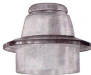
Das Oberteil der Leuchten besteht aus einer Leichtmetallkappe und einem Stahlblech- bzw. Leichtmetallmantel. Die zwei unabhängig voneinander verstellbaren Fassungen mit Gewinde E 27 bzw. E 40 haben kräftige Mittel- und Seitenkontakte aus Bronze und einen Tombak-Metallgewinding.
