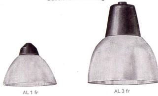
Das Oberteil der Leuchten (gleiches Oberteil wie für Leuchten mit tiefem Emaille-schirm und Leuchten mit flachem Emaille-schirm und Zylinderglas) besteht aus Güßeisen und ist mit einem schwarzen, eingebrannten Lackanstrich versehen. Der Glasschirm wird durch einen besonderen Trageller gehalten, der nach Art eines Bajonett-verschlusses durch verlängerte Sechskantschrauben, die an der Unterseite des Leuchten-oberteils geschützt angeordnet sind, befestigt wird.
